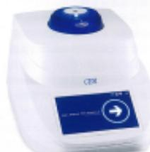
的回波信号而完全隔离了其它杂质的氢核信号。ORACLE 采用全新的独特的直读测量技术。它完全不需要方法制定，不需要任何有毒有害化学试剂，不需要参考其他化学方法的结果。
